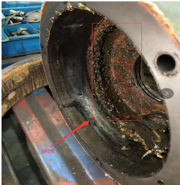
驱动端轴承座锈蚀
