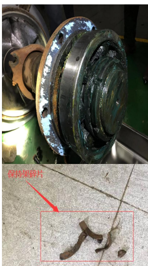
轴承保持架损坏
