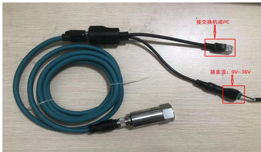
图 4 网线供电合路器连接示意图
