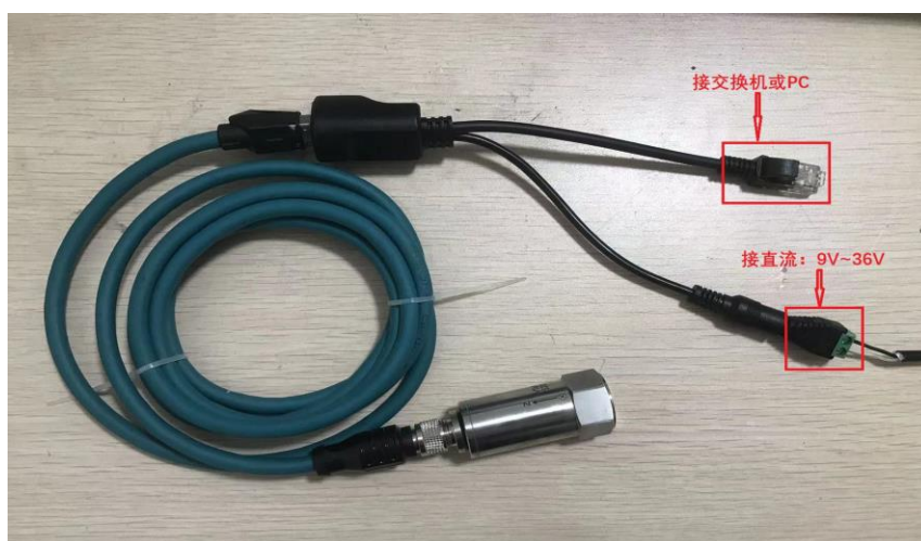
图 3 网线供电合路器连接示意图
